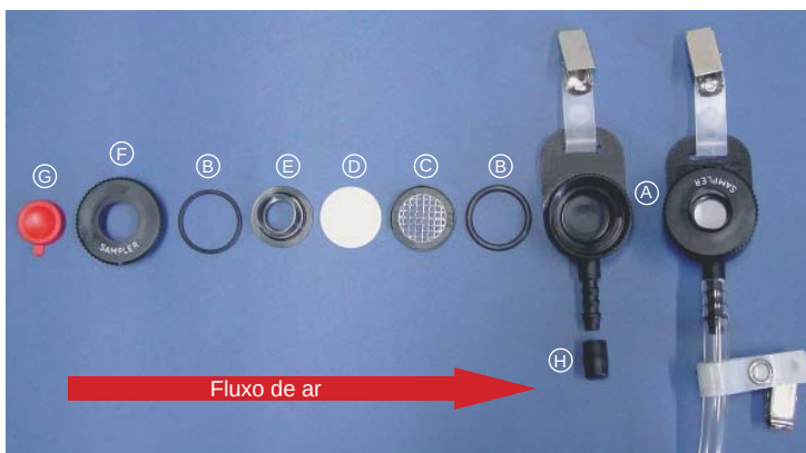
Figura E.5 Dispositivo de coleta tipo IOM para particulado inalável
